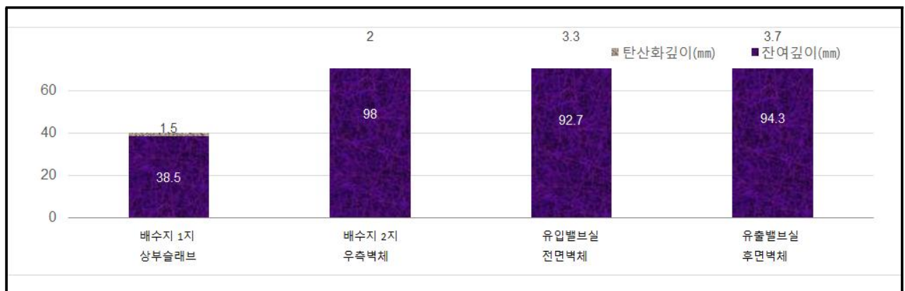
【그림 1.4】반발경도시험 측정결과 그래프(토목)
